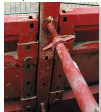
Los orificios rectangulares 35/65 mm con una separación en vertical de 500 mm en las guías deslizantes, posibilitan una colocación óptima de los codales según el tipo de excavación y del diámetro y forma de instalación de la tubería.
