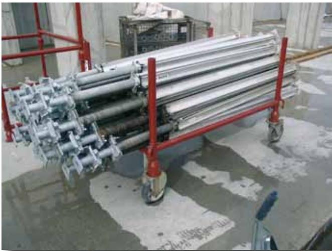
Puntales Alu-TITAN HV en una jaula con ruedas para facilitar los transportes horizontales
